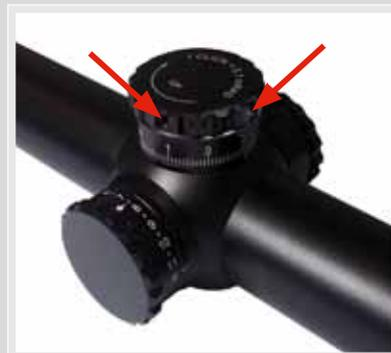
Beide Drehknöpfe können nach dem Einschließen auf 0 zurückgesetzt werden. Um die Drehknöpfe auf 0 einzustellen, lockern Sie mit dem mitgelieferten Inbusschlüssel die Einstellschrauben, die sich direkt am oberen Rand des Drehknopfs befinden.
