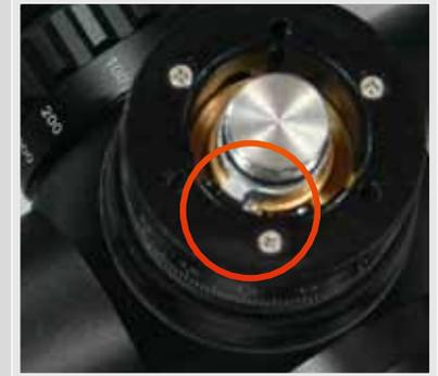
**ACHTUNG** Den Drehknopf für die Höhenverstellung nicht entfernen! Wird der Drehknopf abgenommen, kann die Betätigung der Drehungsanzeige gedreht werden. Das Stellglied regelt den Stift der Höhendrehungsanzeige. Dadurch könnte das Stellglied in eine Lage gebracht werden, die nach dem Zusammenbau die volle Drehung des Drehknopfs verhindert.
