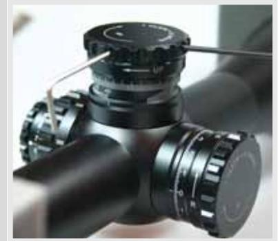
Drehen Sie das Stellglied gegen den Uhrzeigersinn bis es an der Platte hält. Der Stift der Drehungsanzeige wird dadurch zurückgeschoben.
